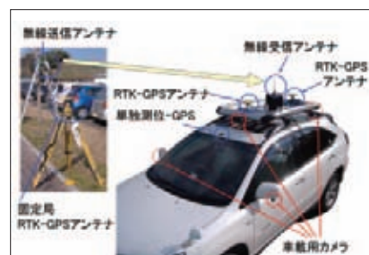
GPSによる位置同定実験(飯塚キャンパス)
